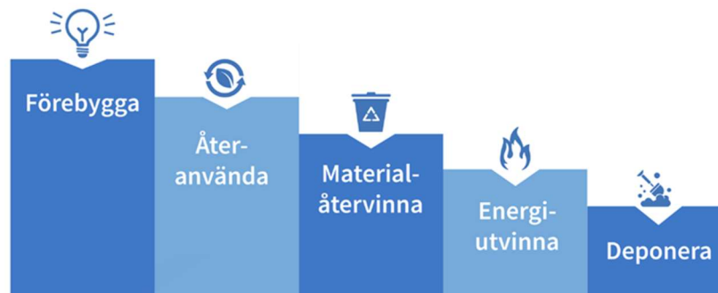
Figur 4. Avfallstrappan. Strategi för att arbeta med material, produkter och avfall.
