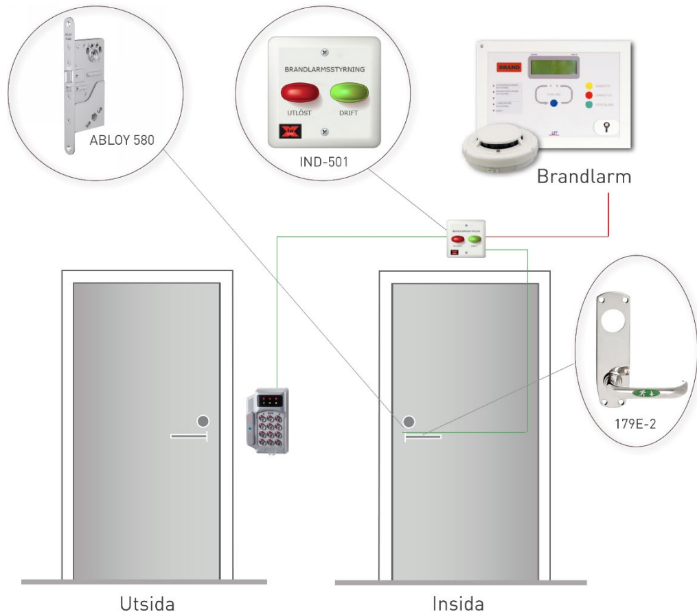
Bild 12.2 visar hur brandlarmet styr passagesystem att låsa upp dörren.
