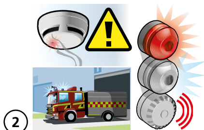
2 Brandlarmet aktiveras. Sirener ljuder och både rött och vitt ljus blinkar där larmet utlösts. I de intilliggande lokalerna blinkar endast vitt ljus. Räddningstjänsten och vakter larmas omgående.
