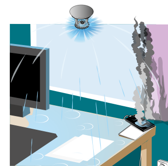
9 Sprinklern ovanför branden aktiveras när branden blir mer omfattande och håller branden under kontroll.
