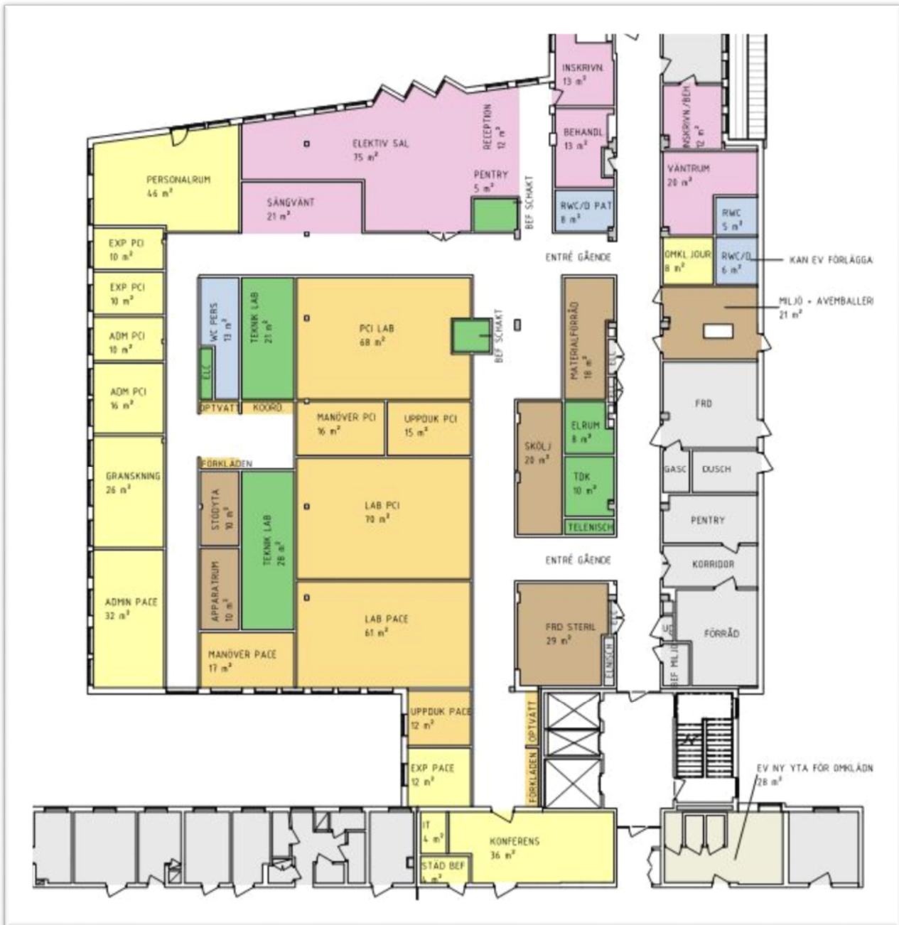
Figur2. Förslag till planritning med befintliga schaktlägen
