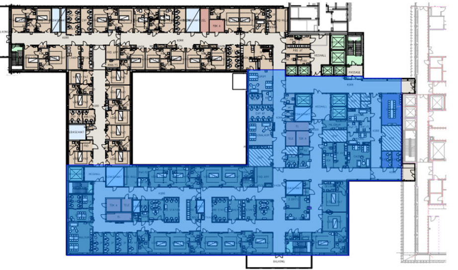
Figur 3, Utbredning av Bjälklagstyp 2 i våning 2-5
